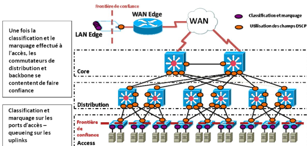
Un certain nombre de fonctions doivent être disponibles sur le commutateur d'accès afin de gérer correctement la QoS nécessaire pour un flux temps réel :
