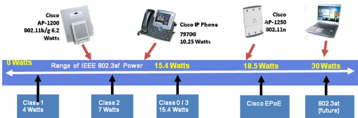
En utilisant la négociation bidirectionnelle CDP, le commutateur peut provisionner les besoins réels en terme de puissance électrique (au delà des quelques classes définies par le standard 802.3af)
