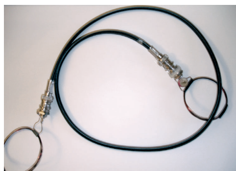
3 Sondes reliées entre elles par un câble coaxial, formant la « rallonge » pour l'attaque par relais
