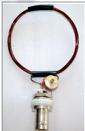
2 Sonde constituée d'un circuit LC
